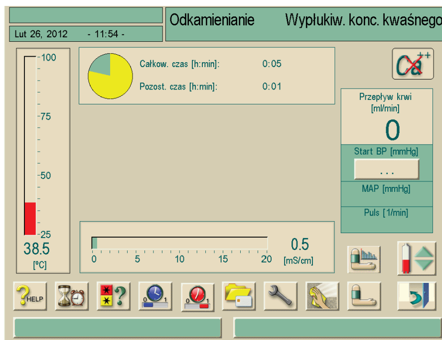
Rys. 8-13 Ekran „Odkamienianie” – wypłukiwanie kwasu
