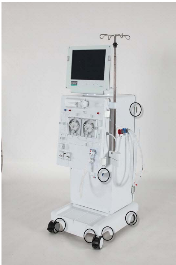
Rys. 4-3 Punkty trzymania podczas przenoszenia urządzenia do dializy
