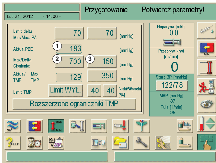
Rys. 6-4 Ekran „Wartości graniczne alarmu” podczas zabiegu
