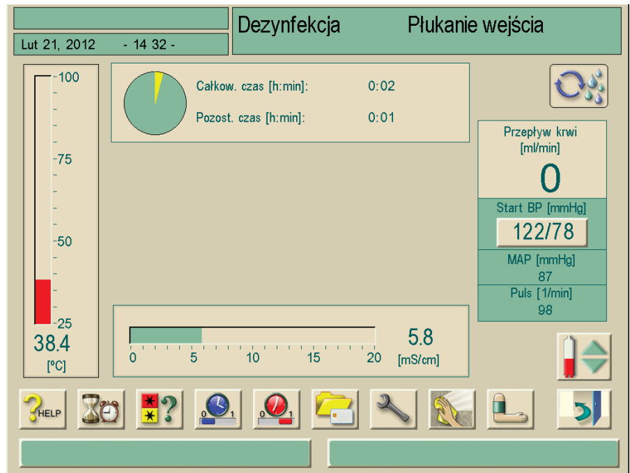
Rys. 8-10 Ekran „Płukanie doprowadzenia wody uzdatnionej”
