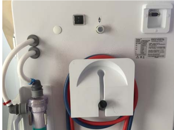
Ábra 4-1 A kábelek, csövek tárolása
