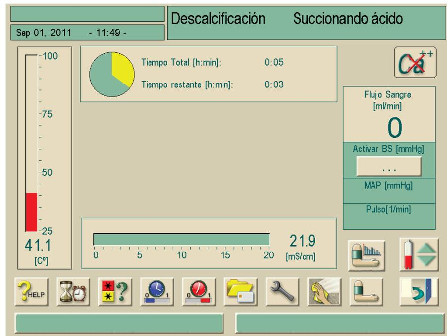
Fig. 8-12 Pantalla "Descalcificación": succión de ácido
